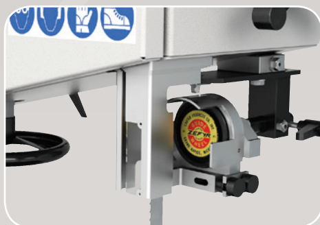
Guidalama superiore di alta precisione CARTER (U.S.A.) Guidelame supérieur de haut pré-cision CARTER (U.S.A.) High-precision top blade guide CARTER (U.S.A.) Hochpräzisions obere Blattführung CARTER (U.S.A.) Guía-sierra superior de alta precisión CARTER (U.S.A.)
